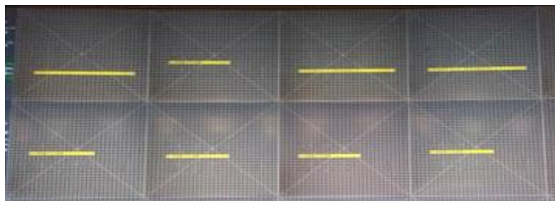
출처: 제작사 시스템설명서(대아티아이(주)) [그림 2-5] 대형표시반의 그리드 조정을 위한 시험 Pattern
