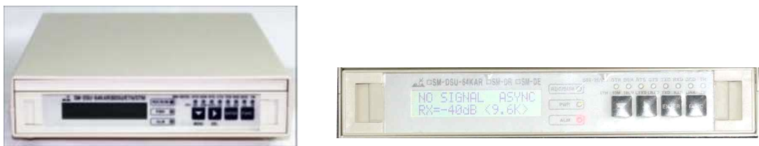
출처: 제작사 시스템설명서(대아티아이(주)) [그림 1-11] DSU 사진이미지 및 표시부분 확대사진
