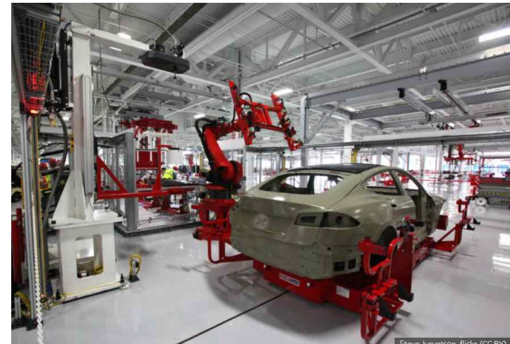
[ 컴퓨터와 로봇 시스템으로 운영되는 테슬라 자동차 조립 공장 ]
