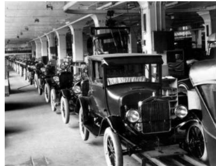
[ T형 포드 자동차 컨베이어 벨트 시스템 ]
